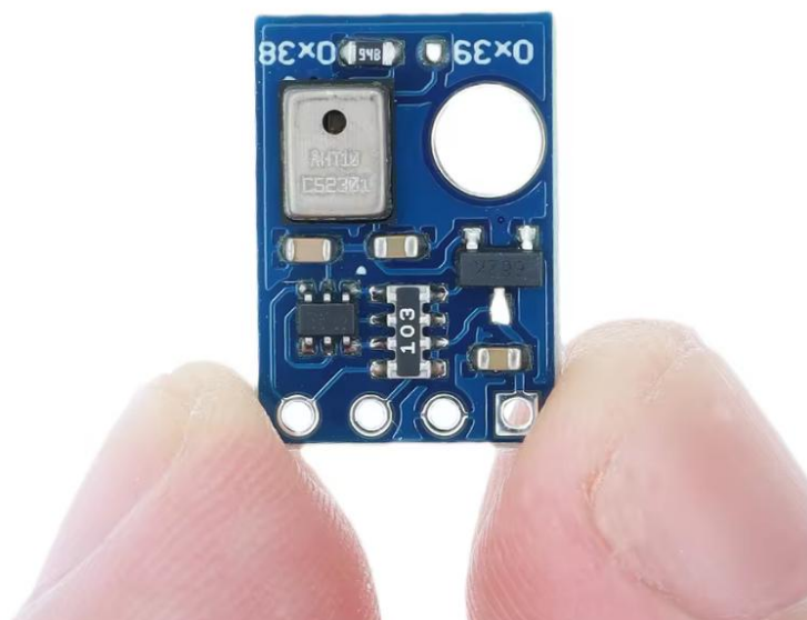
Figura 4 Il sensore ATH10: è solo il blocchetto metallico in alto a sinistra, il resto serve a non confonderlo con una briciola
